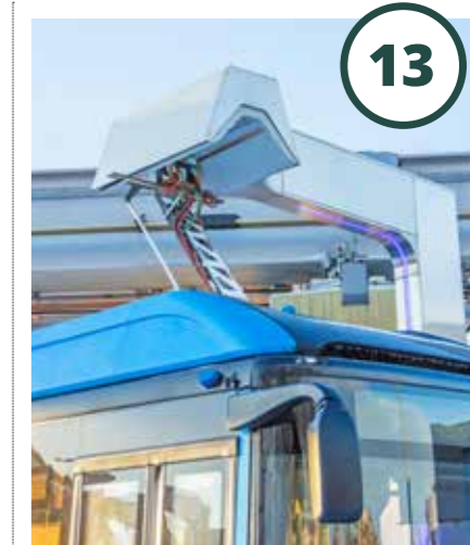
Laddstation för elbuss
